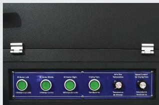
Intuitivo panel de control para sistema de secado, controla la temperatura infrarojo.
