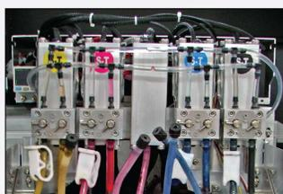
Sistema de presión negativa. Proporcionan mayor alimentación de tinta a los cabezales, permitiendo mas velocidad de impresión.
