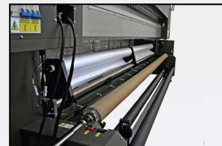
Nuevo sistema de alimentación de material automático, con capacidad para 3 rollos.
