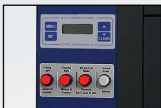
Controles para limpieza de cabezales, incluye inyección de solvente en los cabezales.
